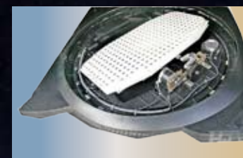
Вся конструкция собрана в один блок весом 23 кг (столько весит пустой аэродинамический багажник Thule), а вся электроника и механика находятся под надежной защитой крепкого пластикового кожуха
