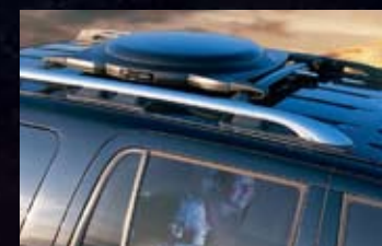
В «грибке» TracVision трудно угадать спутниковую антенну. Она не раскладывается как крышка у лунохода и не вращается – вся конструкция скрыта внутри чрезвычайно низкого и прочного корпуса
